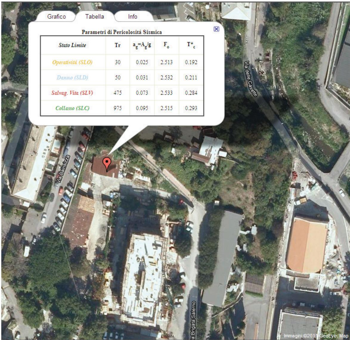
Parametri sismici per Edificio "A"
