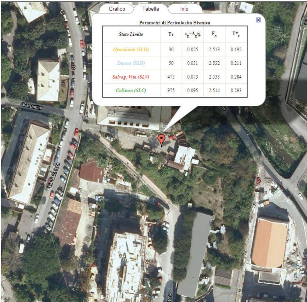
Parametri sismici per Edificio "B"
